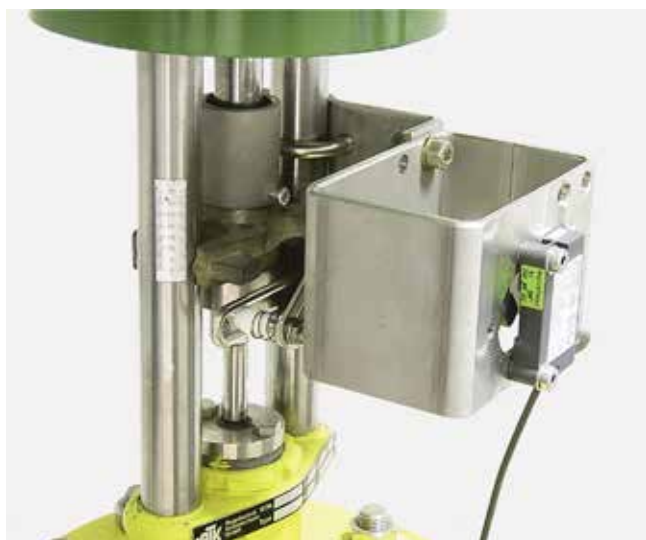
NCS (6DR4004-1.NN30) 用于行程 > 14 mm 使用 NAMUR 直行程执行机构安装组件安装
